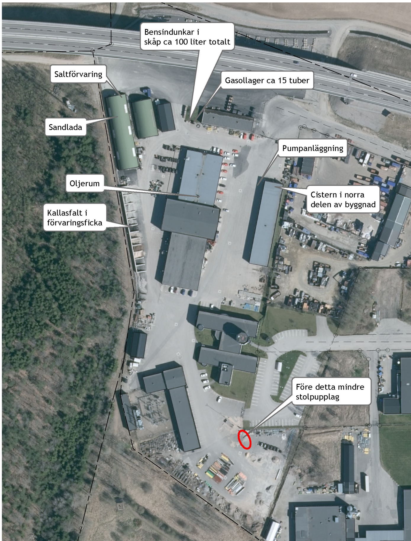
Bild 9. Förvaringsplatser för diverse material som finns eller tidigare har funnits på fastigheten Verkstaden 1.
