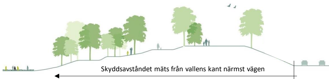
Figur 6. Illustration av hur angivet skyddsavstånd ska mätas då det finns en vall. el. dyl. mot transportleden.
