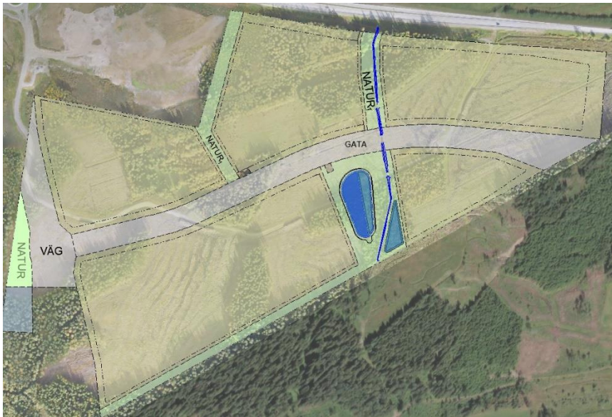
Figur 1. Föreslagen utformning och placering av dammar för hantering av dagvatten.
