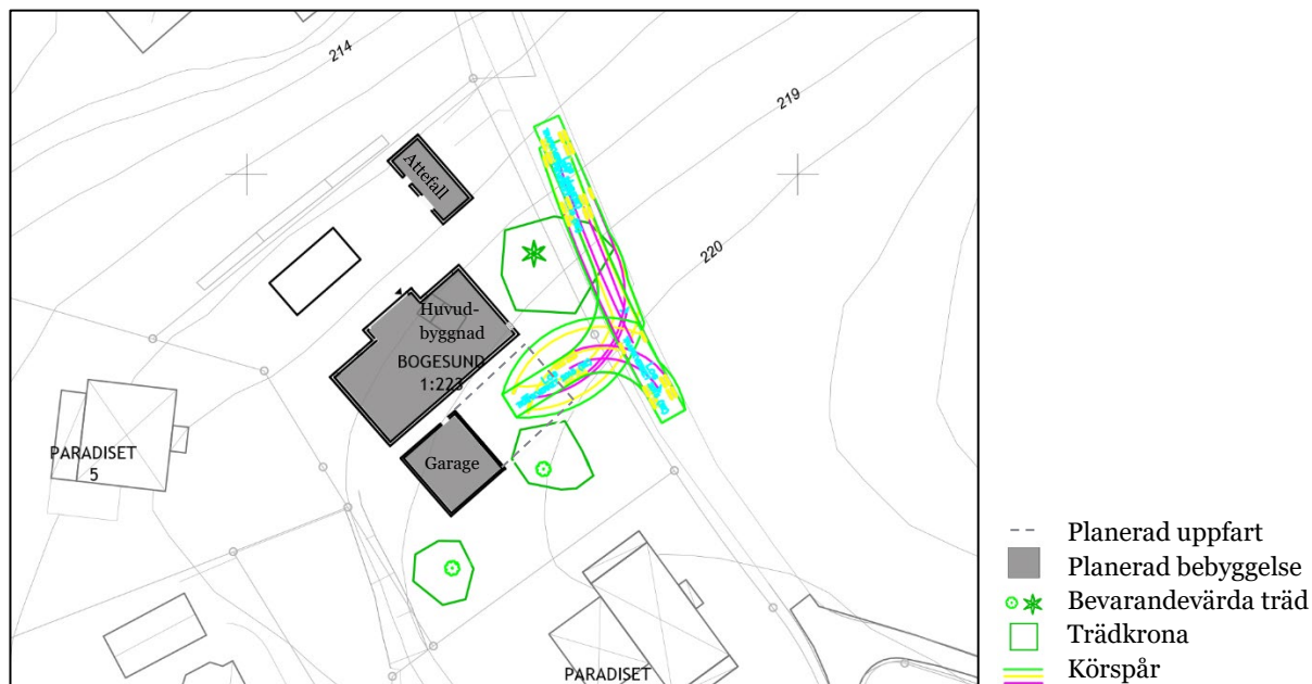
Figur 5. Körspår bekräftar att avfallsfordon kommer kunna vända på planerad uppfart.
