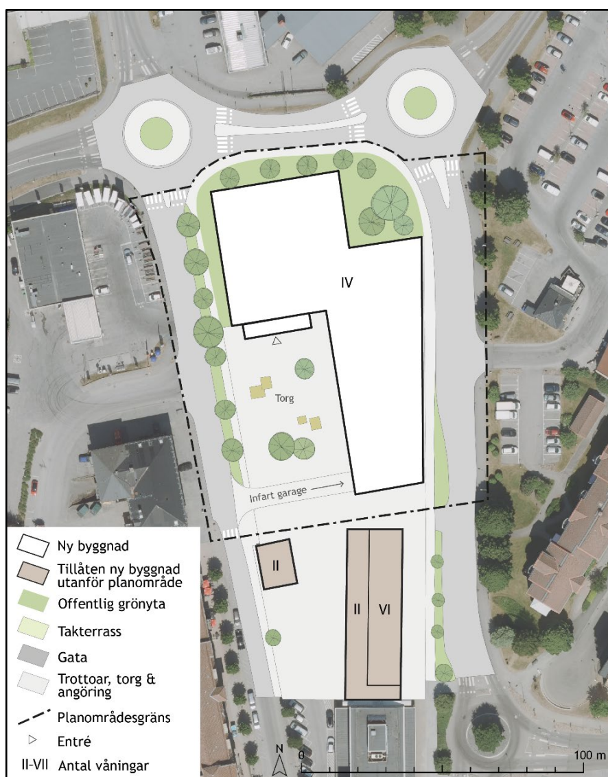
Illustration 1. Illustrationen visar ett exempel på kulturhus på upp till fyra våningar och en byggnadsarea på 3 000 m 2 . Illustrationen är således ett exempel på hur området maximalt skulle kunna utvecklas i enlighet med detaljplanen.
