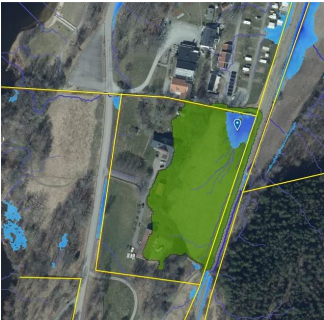
Bild 1: Lågpunkt markerad med blå pil. Grönt området indikerar lågpunktens avrinningsområde. Fastighetsgränser markerade med gula linjer. Bild hämtad från det webbaserade verktyget för interaktiv ytvattenplanering (SCALGO).
