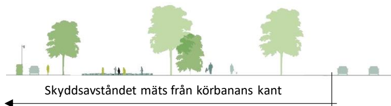
Figur 5. Illustration av hur angivet skyddsavstånd ska mätas med undantag då vall el. dyl. används.
