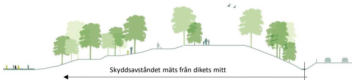
Figur 7. Illustration av hur angivet skyddsavstånd ska mätas då det finns dike.
