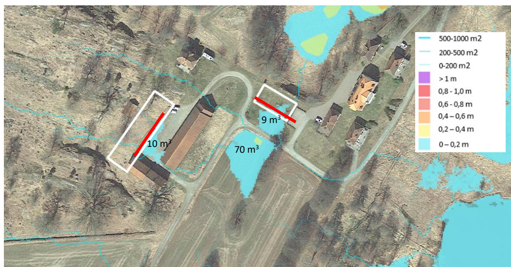
Figur 14. Lågpunkter med ansamlade vatten och rinnvägar vid skyfall, Källa: underlag från Scalgo Live redovisat via QGIS version 3.22.16
