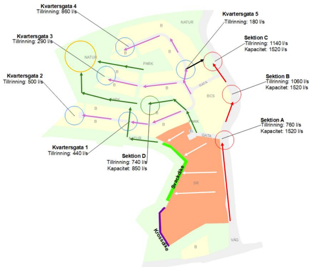
Figur 3. Föreslagen skyfallsavledning vid ett klimatanpassat 100-års regn.
