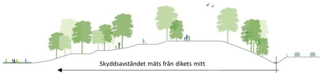
Bild 1: Illustration av hur angivet skyddsavstånd ska mätas då det finns dike.
